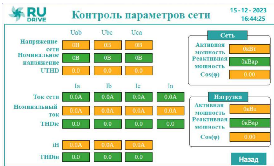
Рисунок 5.3 – Отображение параметров питающей сети
